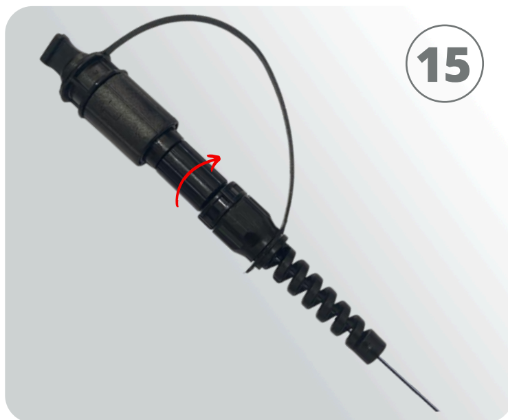
Utilize a orientação da seta do Conector SC/APC alinhada com o "groove" V, destacado em amarelo na figura 12. Para unir e travar as duas peças, segure o tradutor Fast Connect e gire a parte móvel do Corpo Compacto, 1/4 de volta no sentido horário. Ao fim, troque a tampa na haste do Boot, obedecendo o tipo de tradutor utilizado.
