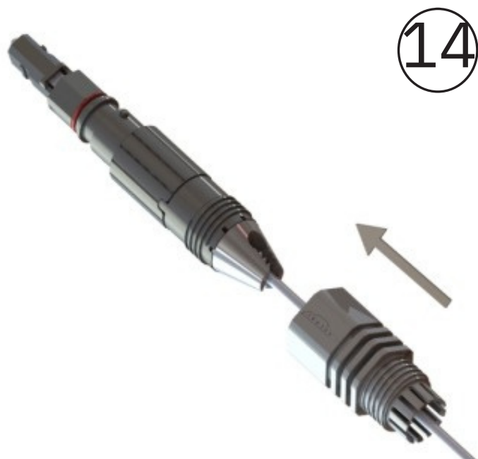
Inserir o fixador do cabo e o flange de vedação no corpo do conector.
